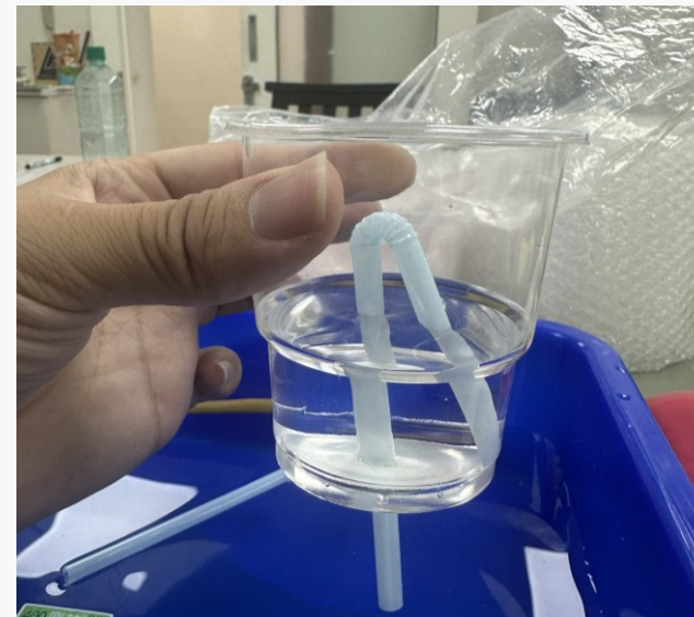
裝一半不漏水
