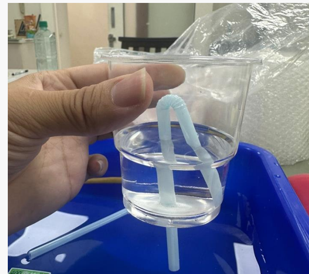
裝一半不漏水
